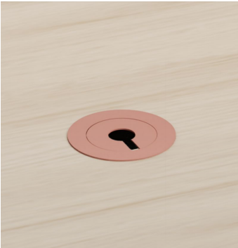
Top Access Redondo - AC072 Ø140mm en soporte / Ø102mm de corte / Ø80mm de paso. Top access metálico redondo con tapa extraíble. Color personalizable.
