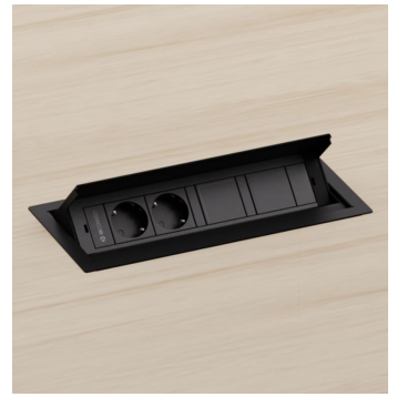
Kit D'Électrification - AC056 319x154mm support / 294x147mm cut out. Électrification a fleur de plateaux avec Ouverture 45°, box en métal avec top rabattable 4 modules oitils. Kit: 2 schukos + 1 HDMI + 2 RJ45 + câble conexión 3 metres. White or black colour.
