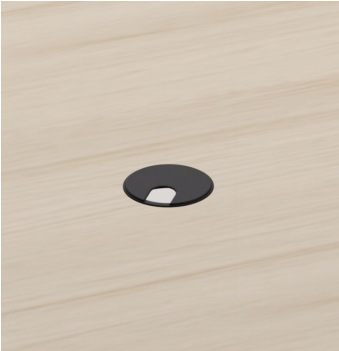
Top Access - AC052 Ø96mm en soporte / Ø80mm de corte. Color blanco, negro o gris.
