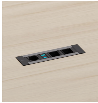
Kit Electrificación - AC071 267,75x78,6mm en soporte / 258,8x67mm de corte. Electrificación en superficie- encimera con 1 schuko + 1 USB carga A y C + 2 RJ45 + 1 HDMI. Color blanco o negro.
