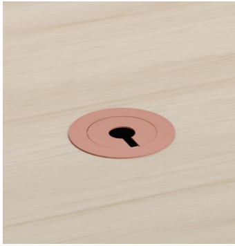
Top Access Rond - AC072 Ø140mm en support / Ø102mm en découpe / Ø80mm en passant. Accès supérieur rond en métal avec couvercle amovible. Couleur personnalisable.
