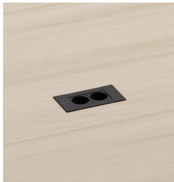
Kit D'Électrification - AC070 144x78,6mm en support / 135x67mm en découpe. Électrification a fleur de plateaux avec 2 schukos Blanc ou noir couleur.
