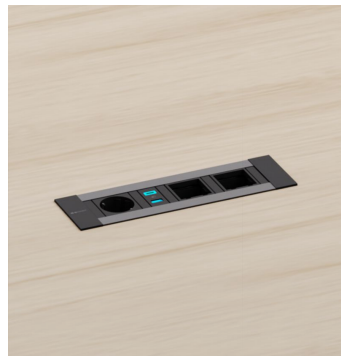
Kit D'Électrification - AC071 267,75x78,6mm en support / 258,8x67mm en découpe. Électrification a fleur de plateaux avec 1 schuko + 1 USB charge A et C + 2 RJ45 + 1 HDMI. Blanc ou noir couleur.
