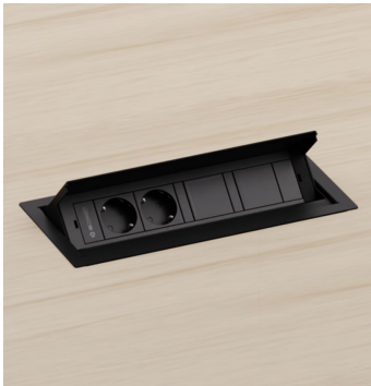
Kit Electrificación - AC056 319x154mm en soporte / 294x147mm de corte. Electrificación en superficie- encimera con apertura de 45º, caja metálica con tapa abatible de 4 módulos útiles. Kit: 2 tomas schukos
